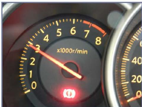
5. 調整油門固定桿,使引擎轉速提高約
