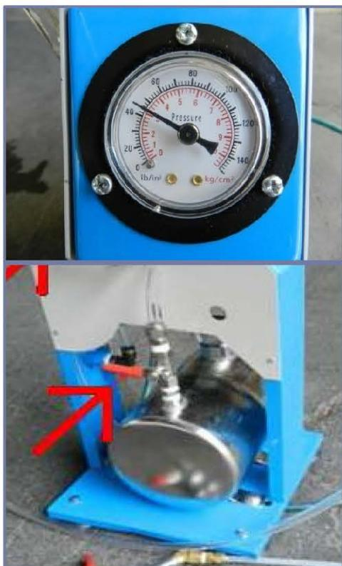
6.調整泡沫機器的壓力值(kg)到 3kg 左右,
